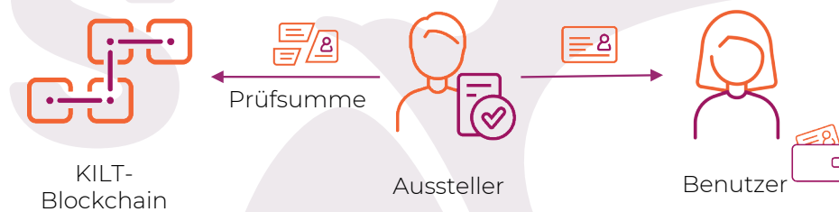
Abbildung 3: Eine Prüfsumme (Hash-Wert) des signierten Dokuments wird auf der KILT Blockchain abgelegt.
